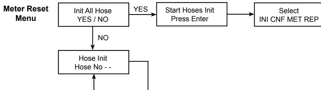
Figure 4: Meter Reset Menu Flow Chart
