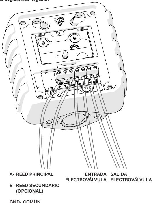
El LED de la tarjeta electrónica permite visualizar rápidamente el estado abierto (LED encendido) o cerrado (LED apagado) de la electroválvula, en caso de que esta se encuentre instalada en la línea. Asegúrese de su conexión correcta a los polos positivo y negativo de la tarjeta. La tensión de alimentación no deberá exceder los 30 V.
