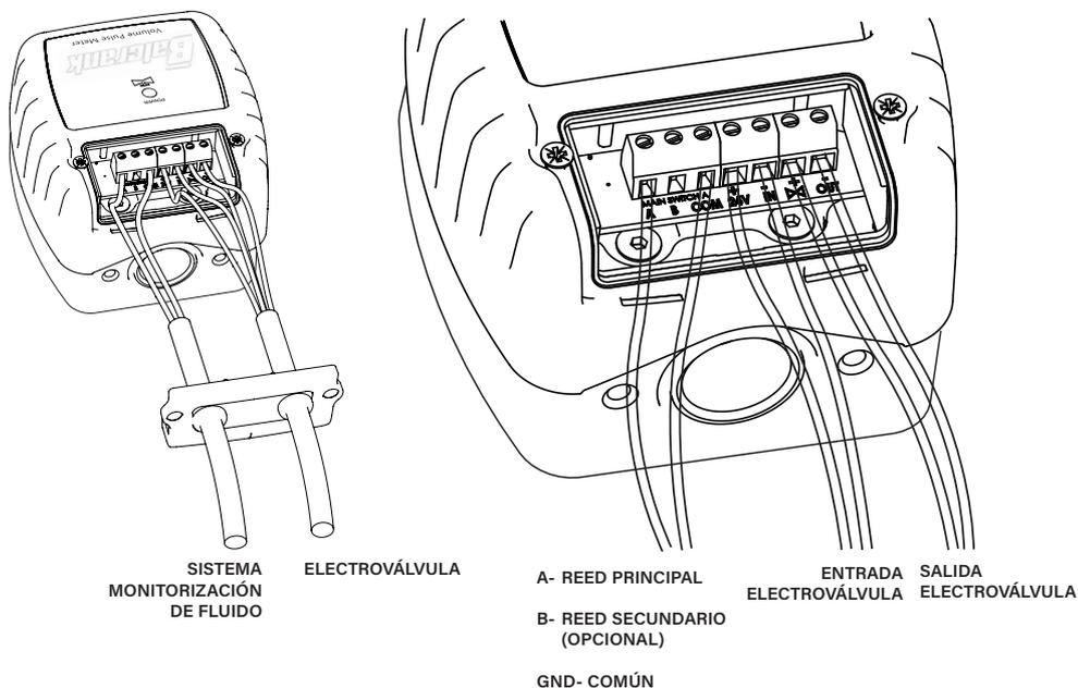
El LED de la tarjeta electrónica permite visualizar rápidamente el estado abierto (LED encendido) o cerrado (LED apagado) de la electroválvula, en caso de que esta se encuentre instalada en la línea. Asegúrese de su conexión correcta a los polos positivo y negativo de la tarjeta. La tensión de alimentación no deberá exceder los 30 V.
